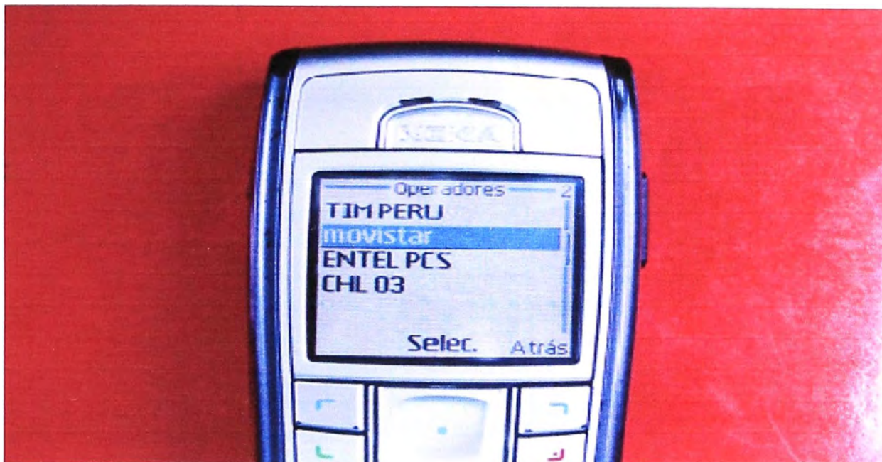
Figura 6.24.- Equipo de abonado utilizado como detector de servicio
