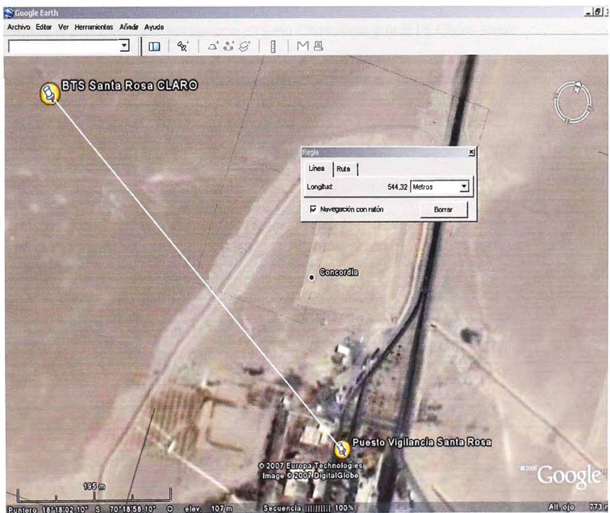
Figura 6.19.- Distancia entre la BTS de Claro - Perú y el Puesto peruano de Aduanas Santa Rosa.
