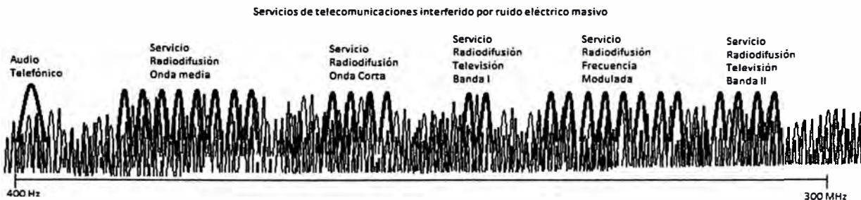
Figura 1.4.- Interferencia por invasión masiva de campo eléctrico
