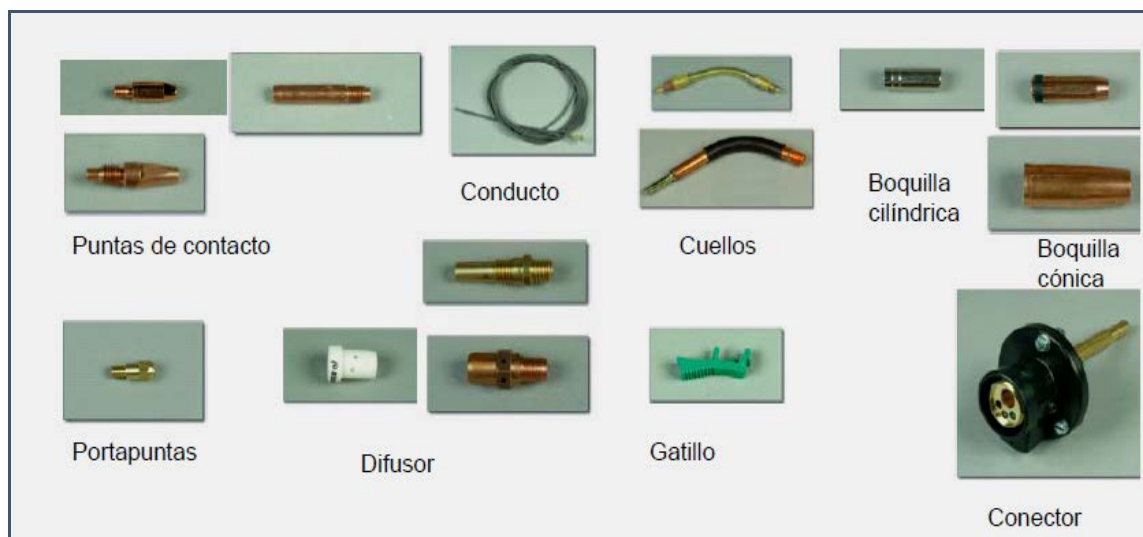
Fig.22. Diversos elementos de una pistola Mig-Mag
