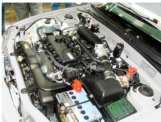
Fig. 1. Ejemplo de un motor Bi- Fuel: Marca Hyundai, modelo Taxi AFCENT , 1,5lt, 4 cilindros, 91 HP (a 550rpm) [21]
