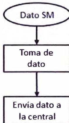
Figura 5.31 Diagrama de flujo de la subrutina del sensor
