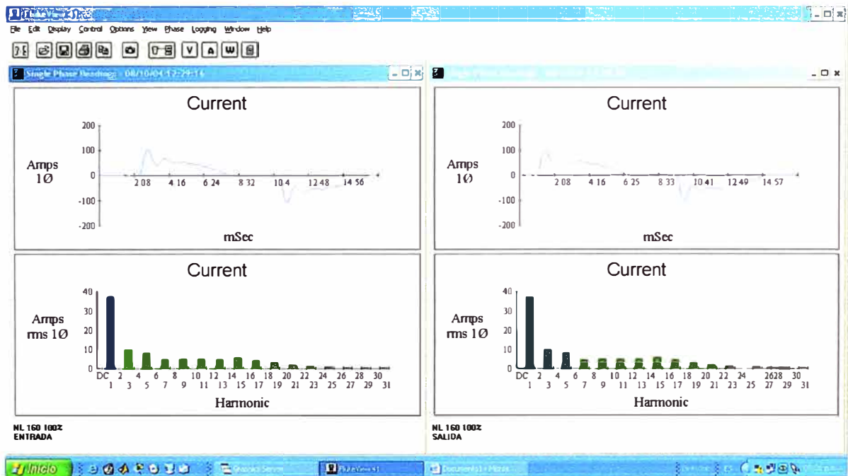
Figura 6.30 Gráfico de Corriente para una Tensión de Entrada 160V y 100% de Carga No Lineal
