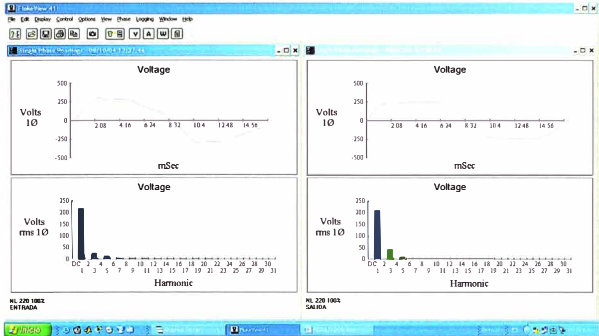
Figura 6.37 Gráfico de Tensión para una Tensión de Entrada 220V y 100% de Carga No Lineal
