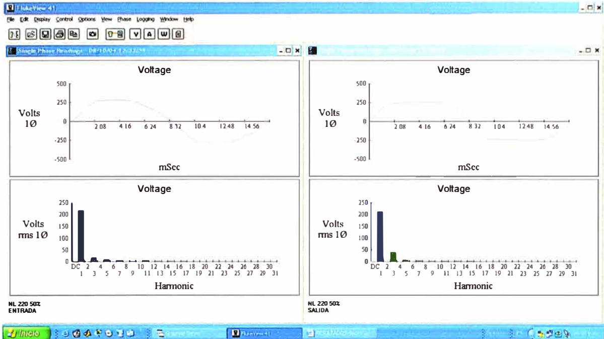
Figura 6.33 Gráfico de Tensión para una Tensión de Entrada 220V y 50% de Carga No Lineal
