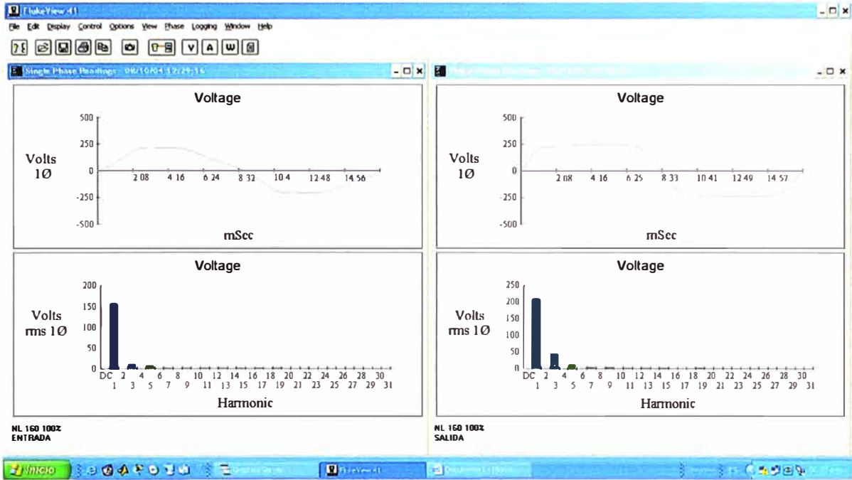
Figura 6.29 Gráfico de Tensión para una Tensión de Entrada 160V y 100% de Carga No Lineal
