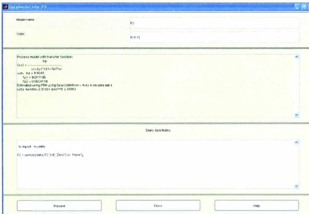
Fig.B.6 Función de Transferencia del Motor DC para 5V.
