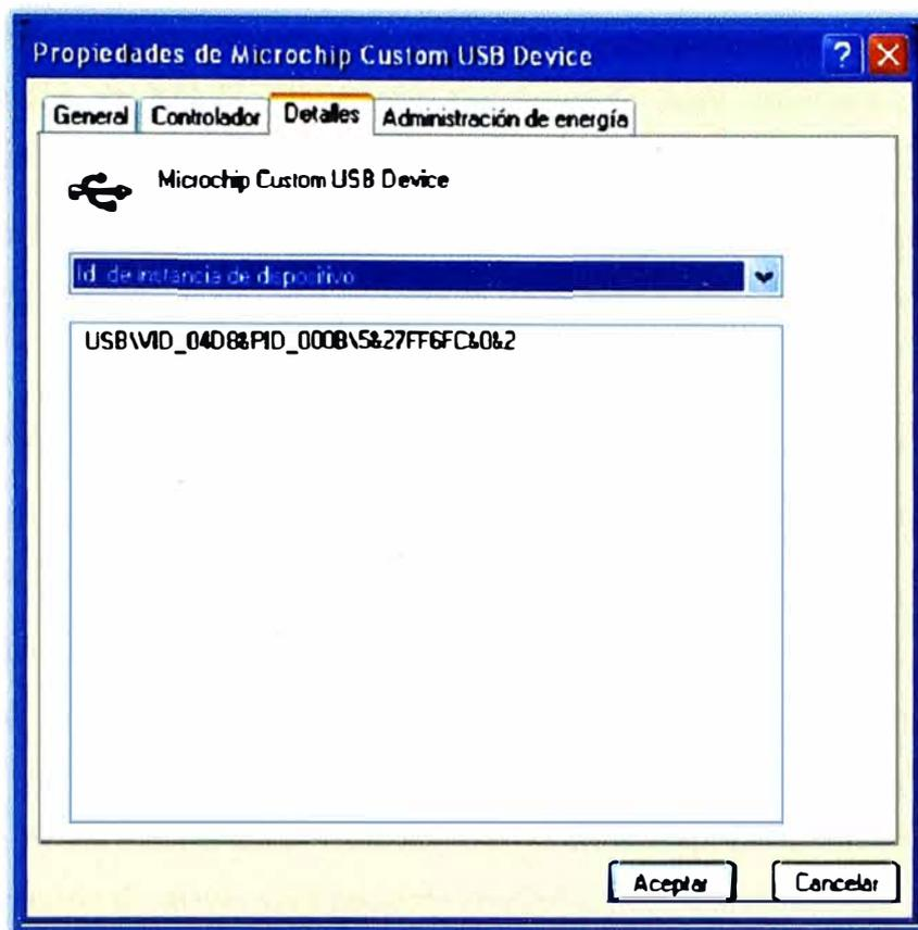
Fig. 3.2 En propiedades del PIC instalado en la PC se observa el numero de PID&VID.
