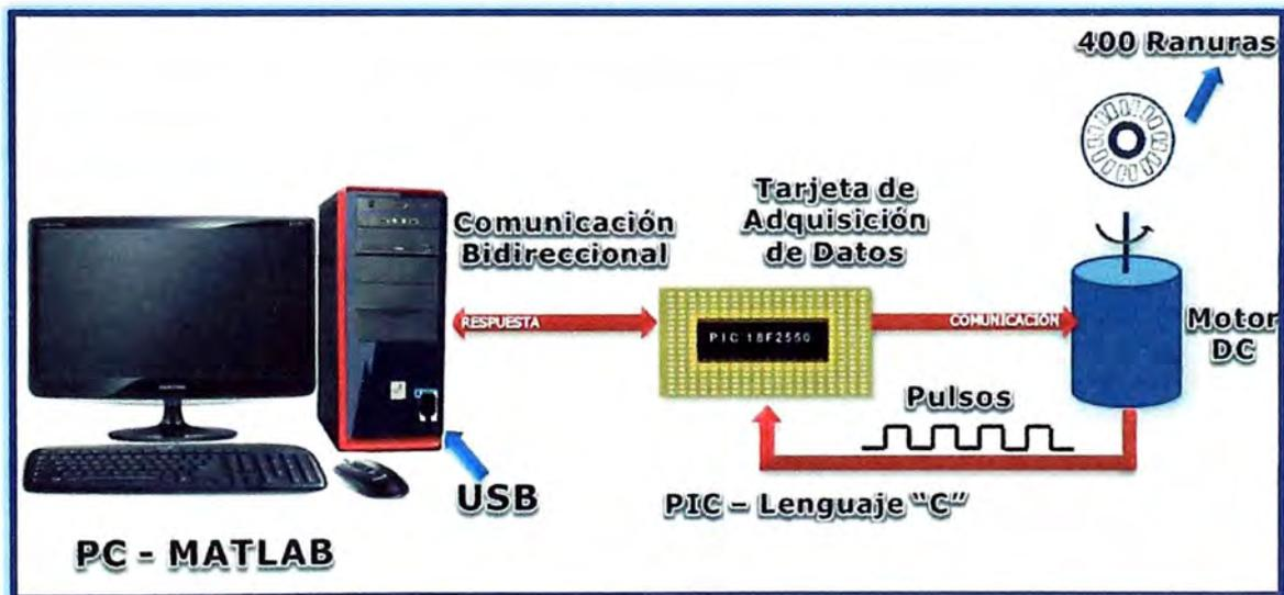
Fig. 4.3 Descripción del sistema de Transferencia de Datos
