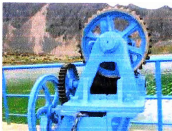
Figura N° 4.5. Mecanismo de accionamiento en Canchis. Volante con reductor y cremallera.
