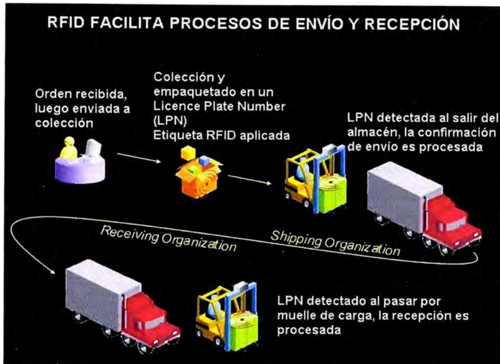
Figura 2.1 Intervención de la RFID en procesos de envío y recepción. Fuente: "RFID Enabled Shipping and Receiving" http://oracleebusinesssuite.wordpress.com/2007/12/17/rfid-enabled-shipping-and-receiving/
