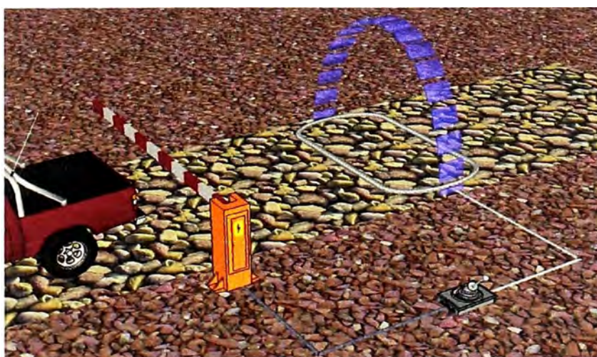
Figura 3.4 Cierre automático post ingreso de vehículo autorizado. Fuente: Elaboración propia.
