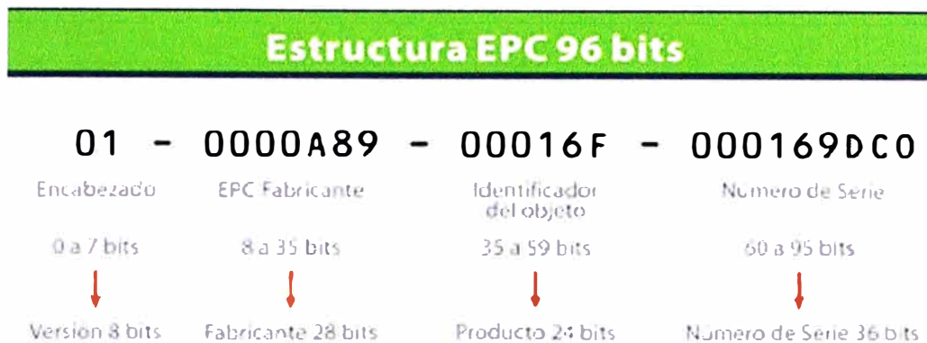
Figura 2.13. Estructura EPC 96 bits
