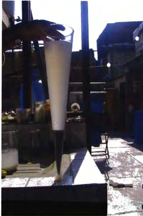
Medición del nivel de Sólidos Sedimentables en el cono Imhoff.
