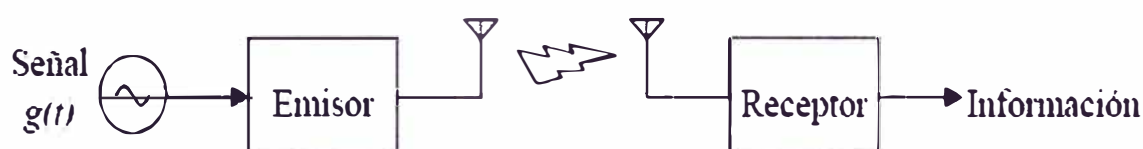
Fig. 2.7 Sistema de comunicaciones de radiofrecuencia
