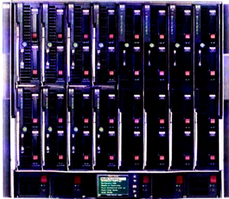
Figura 3.4 Servidores Blade (dos filas de 8), dentro de un Chasis Blade
