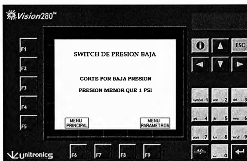
Fig. 4.6 Estado del Switch en el Punto de Falla
