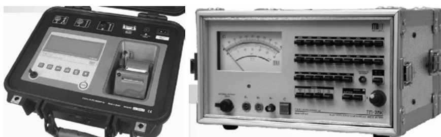
Fig. 3.8.- Telurómetro de Corriente de Alta Frecuencia TM-25m y TM-25k marca Megabras
