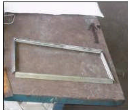
Figura 3.13. Marco preparado para soldadura.
