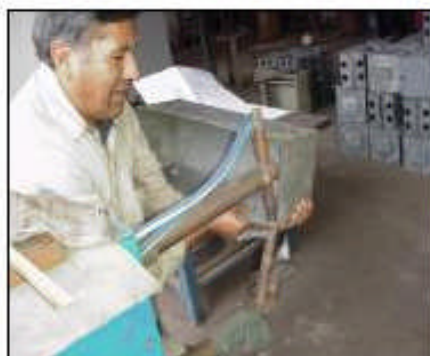
Figura 3.16. Soldadura de cajón y tapas superior e inferior.
