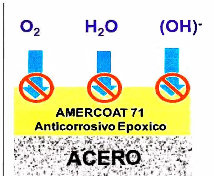
Figura 14: Protección por Pigmento inhibidor
