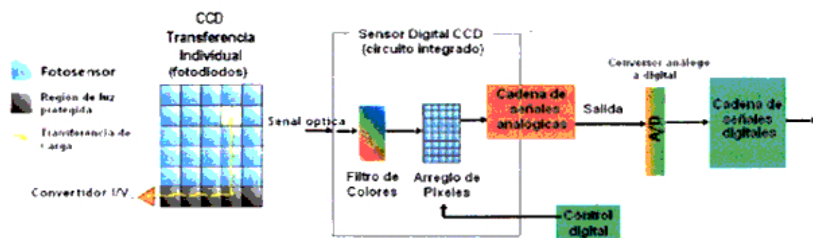
Figura 14. La transferencia de la señal eléctrica de un pixel tiene que ser transmitida de pixel a pixel para conseguir su posterior lectura. Se muestra que el sensor de imagen CCD transforma la señal óptica (fotones) en señales eléctricas analógicas.
