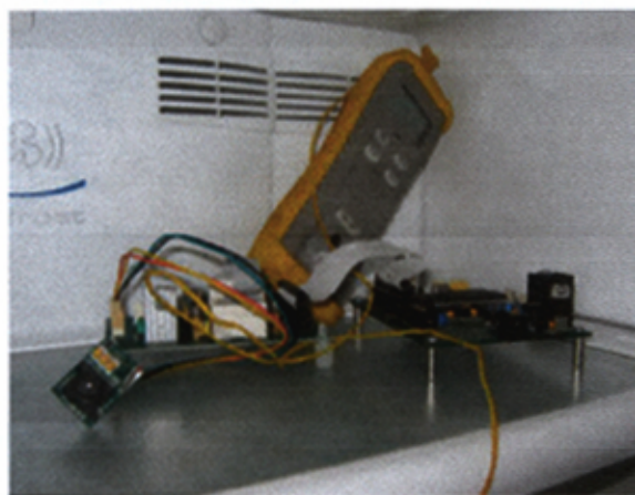
Figura 70. El equipo dentro del ambiente temperado. Tenemos la termocupla y termómetro digital para monitorear la temperatura.
