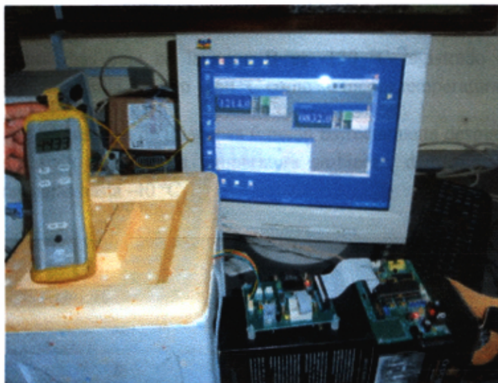
Figura 73. Sistema implementado para la segunda prueba de temperatura. Se observa que el termómetro digital registra -143.3^{\circ}\text{C} en la fotografía.
