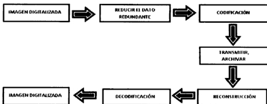
Figura 29. Diagrama de bloques del algoritmo básico para la compresión de archivos.
