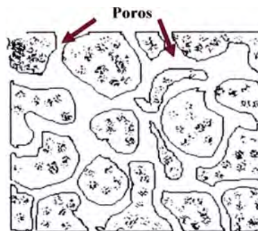
Figura 2.9 Estructura de poros abiertos o interconectados.
