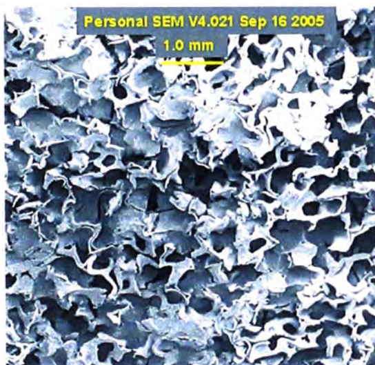
Figura 5.19 Filtro poroso con arcilla natural.
