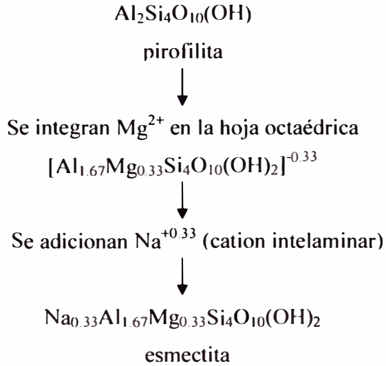
Figura 2.3 Formación de minerales arcillosos por sustitución isomórfica.
