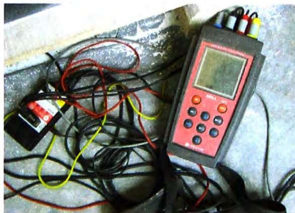
Fig. 3.1 Analizador de redes AR-5L
