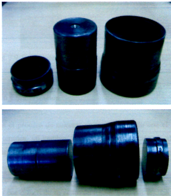
Fig. 3.8. Matriz de acero, diseñada especialmente para la fabricación de los filtros.
