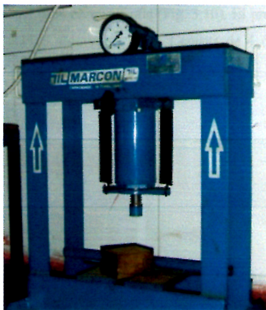
Fig. 3.9. Prensa hidráulica, genera hasta 10 toneladas de fuerza.
