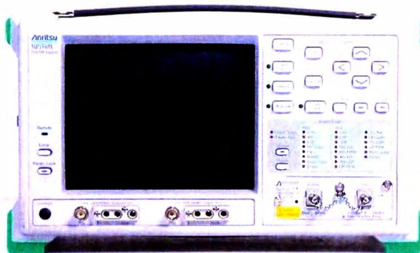
Figura 3.29 Medidor de BER MP1550A, Anritsu
