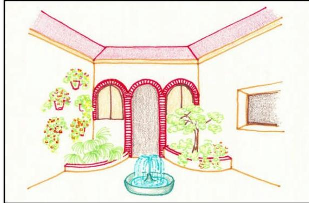
Figura 2.37. Un patio dentro de la edificación funciona como un sistema de enfriamiento por radiación nocturna, (García, 2 009).
