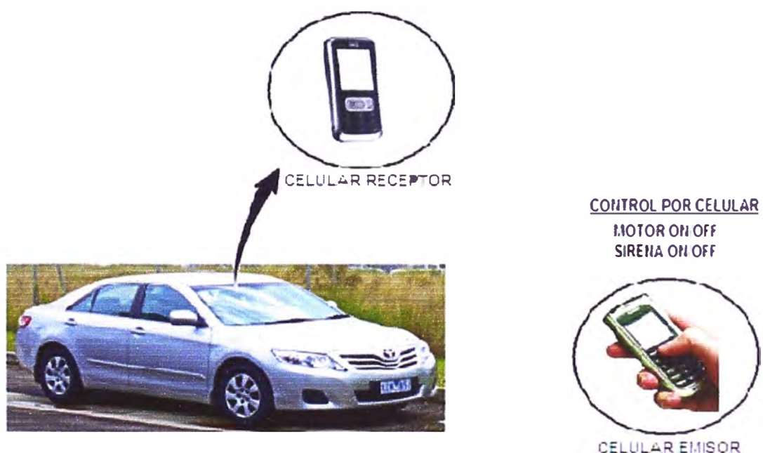
Figura 1.3 Control de Alarma a distancia por Celular
