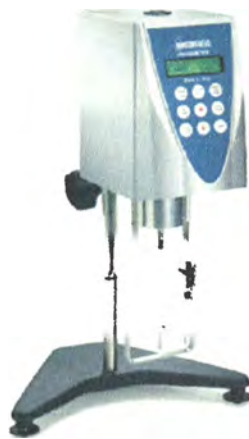
Figura II.10 Viscosímetro de Brookfield
