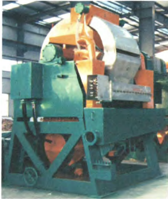
Figura II.28 SLON. Separador de alto gradiente magnético
