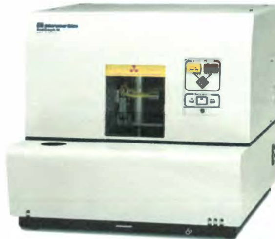
Figura II.6 Equipo SediGraph para la medición del tamaño de partículas
