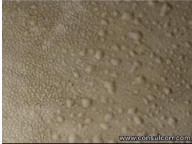
Figura A4.1. Superficie con ampollamiento
