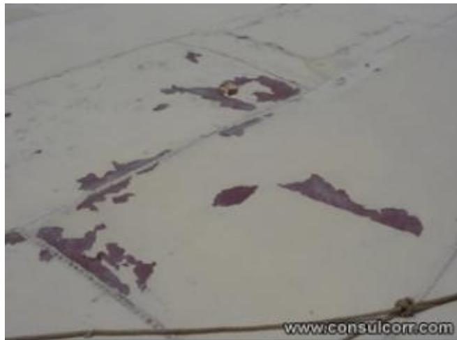
Figura A4.2. Superficie con delaminación
