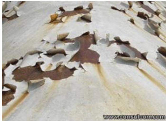
Figura A4.6. Falla en la adhesión
