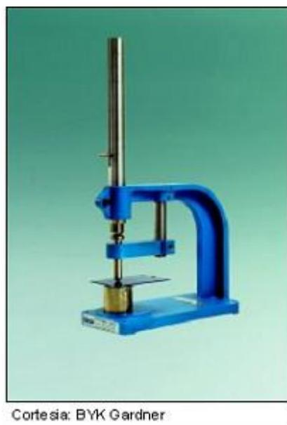
Figura 3.38. Medidor de Resistencia al impacto
