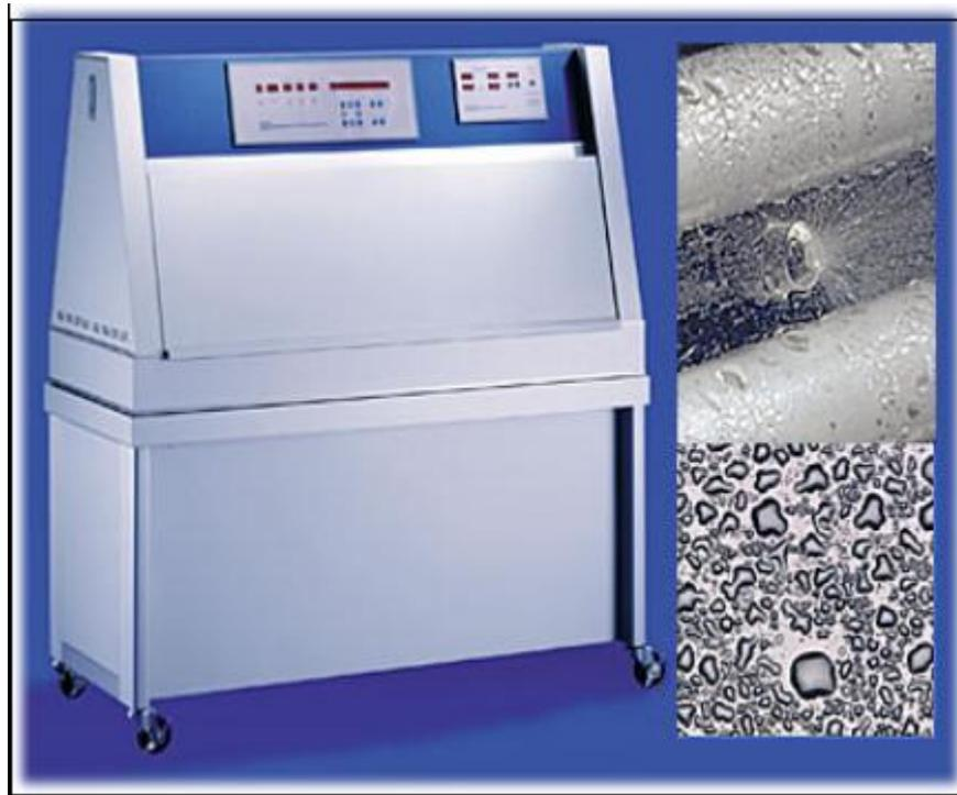
Figura 3.32. Cámara de envejecimiento acelerado
