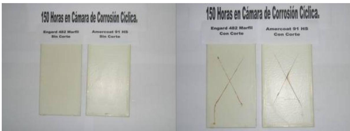
Figura 3.31. Muestras expuestas a la cámara de corrosión cíclica
