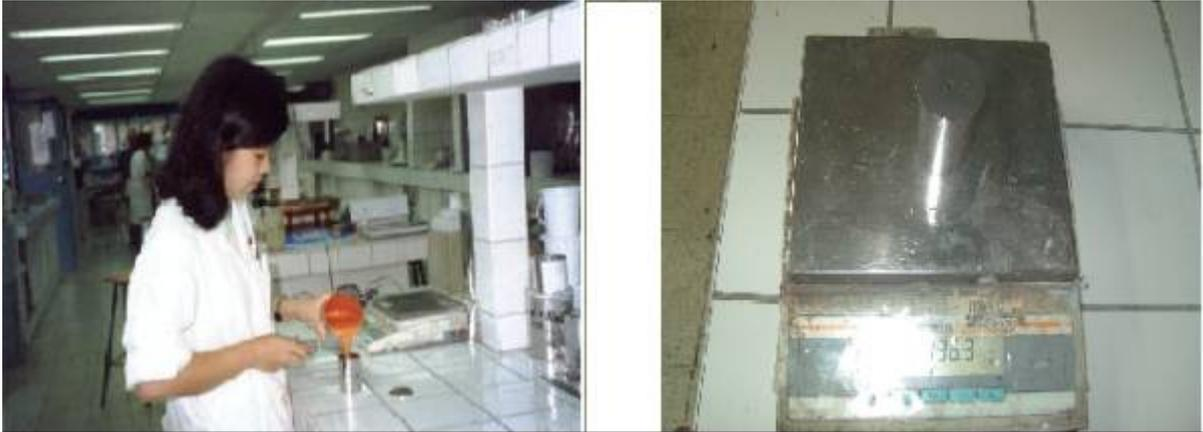
Figura 3.18. Obtención de la densidad de una pintura
