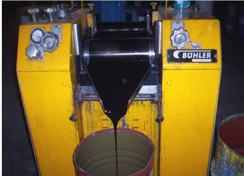
Figura 3.7. Molino Tri-cilindrico en operación
