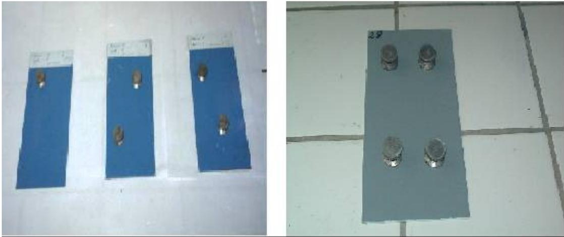
1. Figura 3.26. Medida de la adhesión (Adhesión pull-off)
