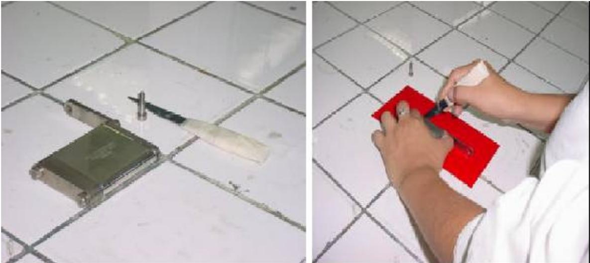
Figura 3.25. Medida de la adhesión (Adhesión por cuchillas)
