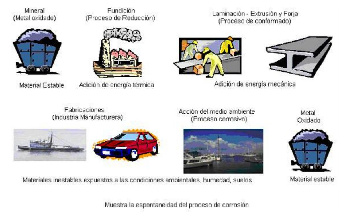
Figura 4.2. Espontaneidad del proceso de corrosión
