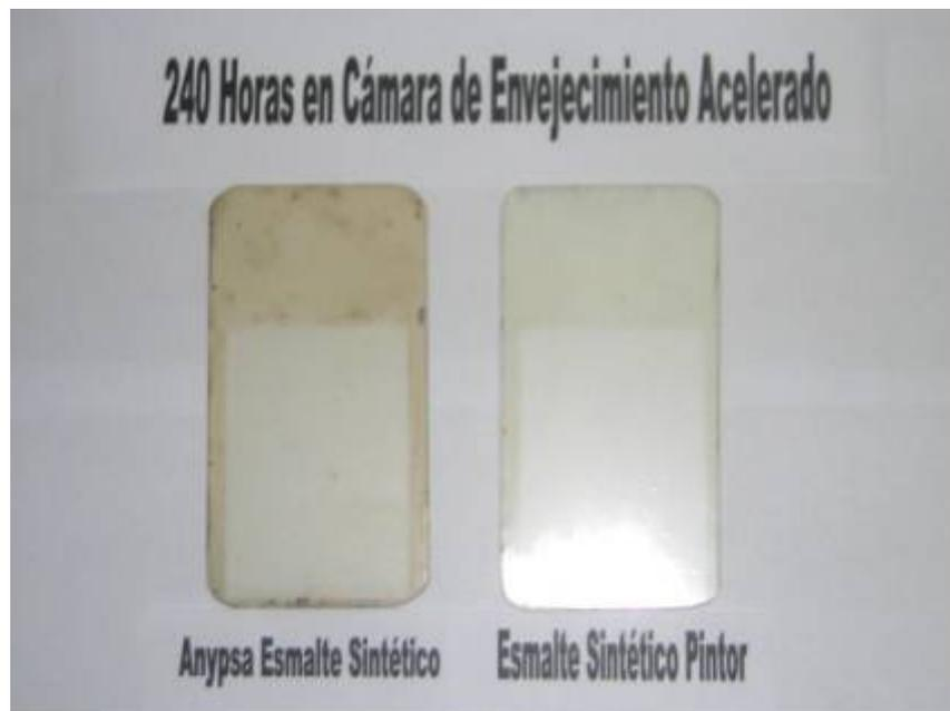
Figura 3.33. Muestras expuestas a la cámara De envejecimiento acelerado
