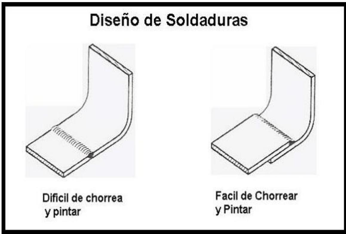
Figura 4.4. Diseño de soldaduras
