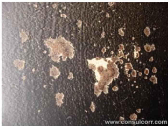
Figura A4.4. Película con erosión
