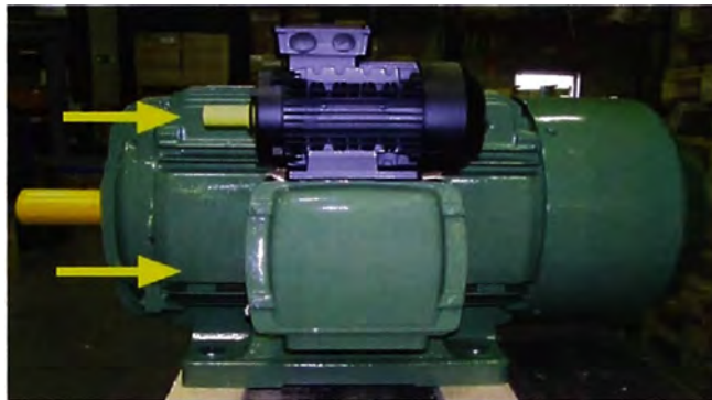
Fig. 3.8 Ejemplo selección errónea del tamaño del motor
