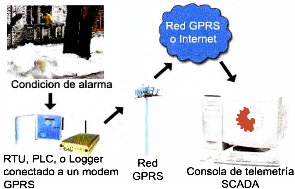
Figura 2.3 Esquema del funcionamiento de telemetría
