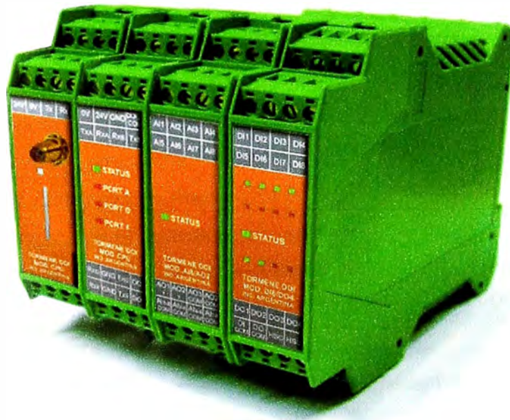
Figura 3.4 Módulo adquirente de datos TADDI RTU
