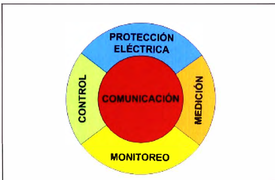
Figura 1.1 Estructura Funcional de la Automatización de Subestaciones
