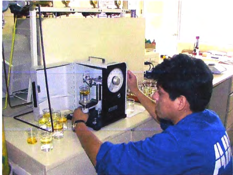
Fig. 2.4 Muestra de prueba de tensión interfacial
