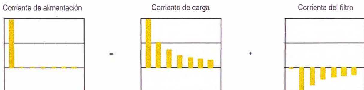
Fig.3.5: Principio del Método de Filtrado del Dominio de frecuencias
