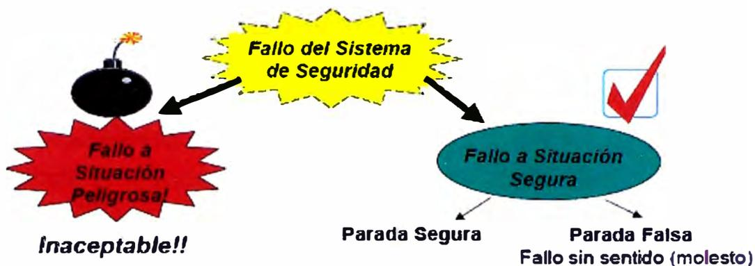
Fig. 4.7 Fallo del sistema de seguridad
