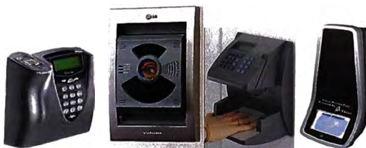
Fig.2.6 Sistema de Control de Acceso. Dispositivo lector de huella, Iris y Mano, Rostro [78,79,80,81].
