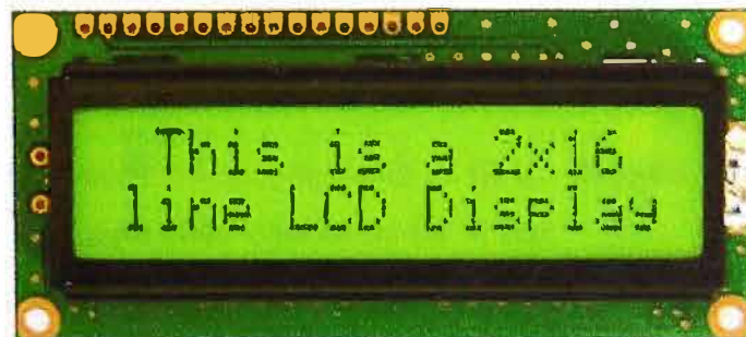
Figura 2.13 Pantalla LCD comandada por un microcontrolador
