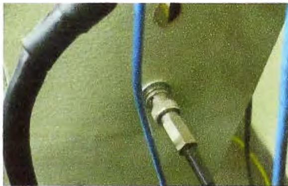
Figura 4.4 Terminal para ingreso de pulsos del patrón
