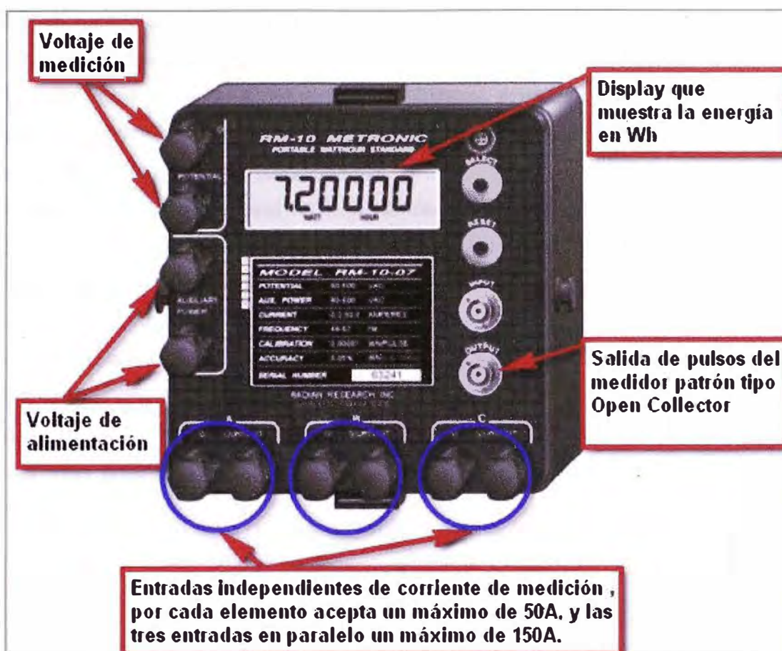
Figura 3.8 Partes del medidor patrón
