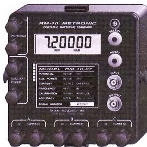
Figura 2.11 Medidor patrón de energía eléctrica de clase 0,05%
