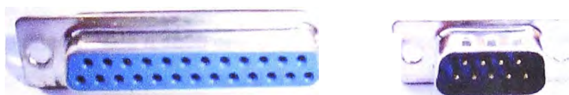
Figura 2.15 Conector DB25 hembra y DB9 macho
