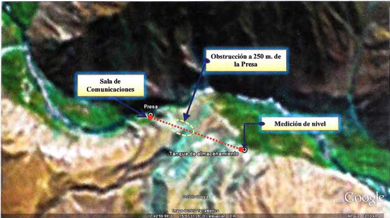
Figura N° 1.3 Obstrucción en línea de enlace directa
