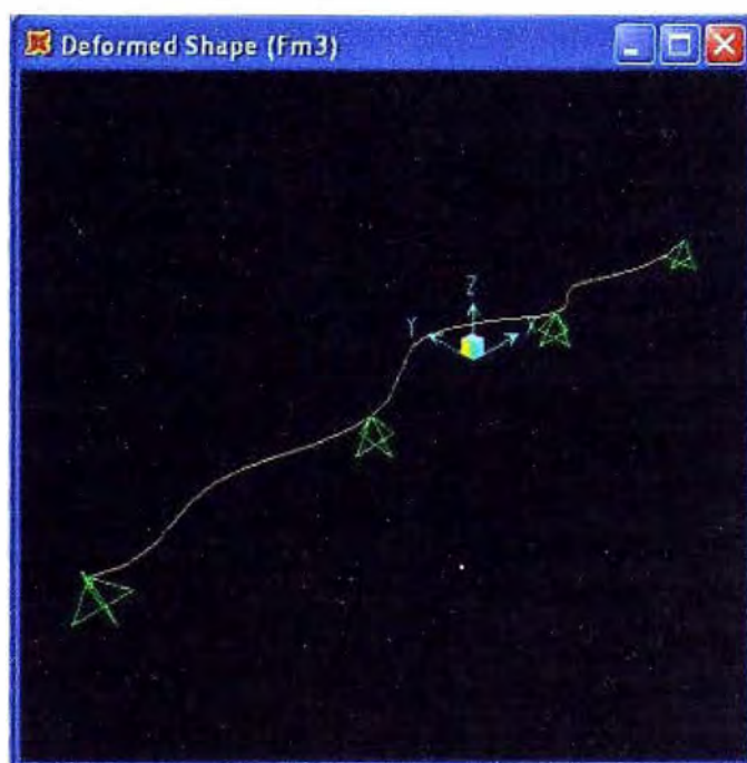
Fig. 4.27: Deformación debido a la carga viva.
