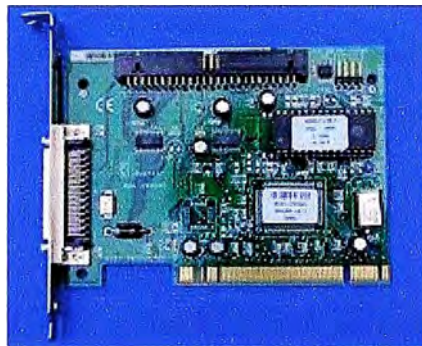
Figura 7 Típica tarjeta PCI de 32 bits. En este caso, una controladora SCSI de Adaptec
