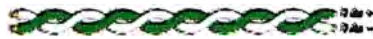
Figura 17 Los cables de datos son un par trenzado para reducir el ruido y las interferencias.
