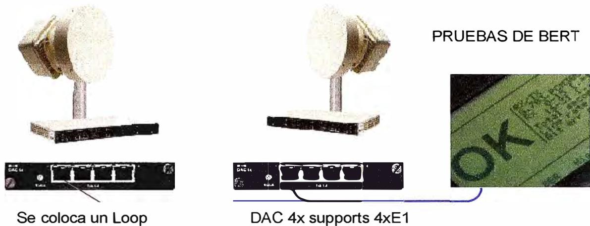
**Fig.2.7** Pruebas de BERT en un enlace inalámbrico
