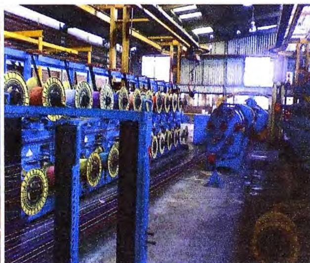
Fig. 2.21 Cableadora de pares
