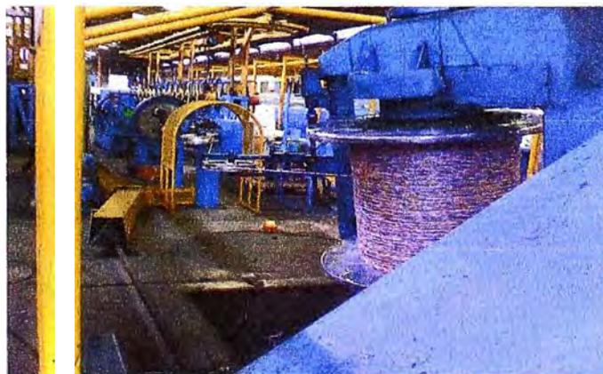
Fig. 2.5 Cableadora de pares
