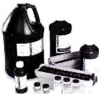
Figura 30. Patrones de Calibración de Formazina HACH
