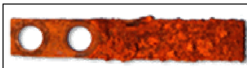
Figura 11 Cupón de corrosión expuesto a un medio corrosivo
