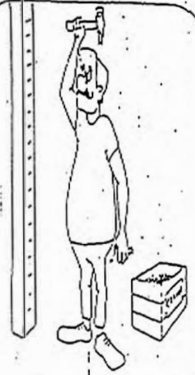
Los clavos serán un soporte sobre el cual recostaremos el Fibrablock al momento de asentarlo.
