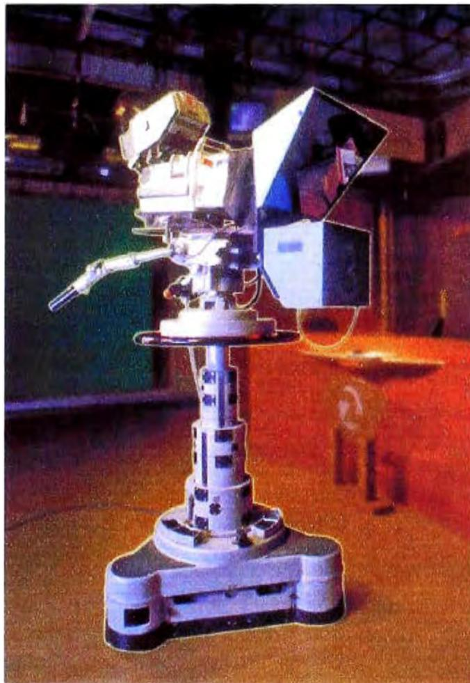
Fig. 1.18 Cámara de estudio con pedestal neumático
