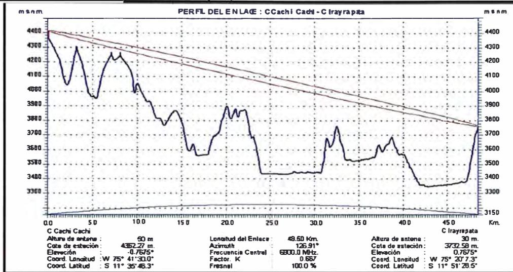
Fig 2.11 Perfil de enlace Co Cachi Cachi – Co Irayrapata para K = 0.66 (Software ACPLINK)
