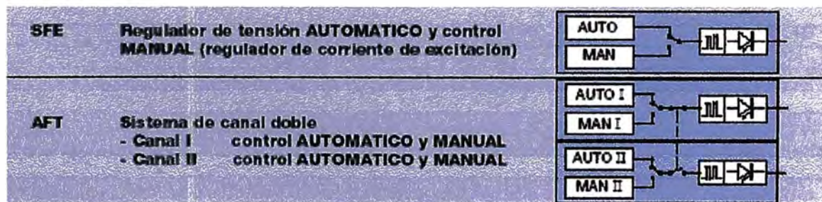
Fig. 1: Configuraciones principales del sistema UNITROL F
