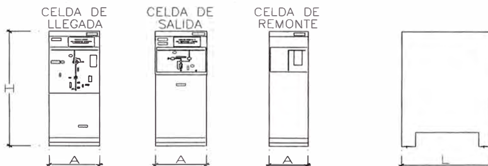
Fig. 2.5 Celdas de media tensión.
