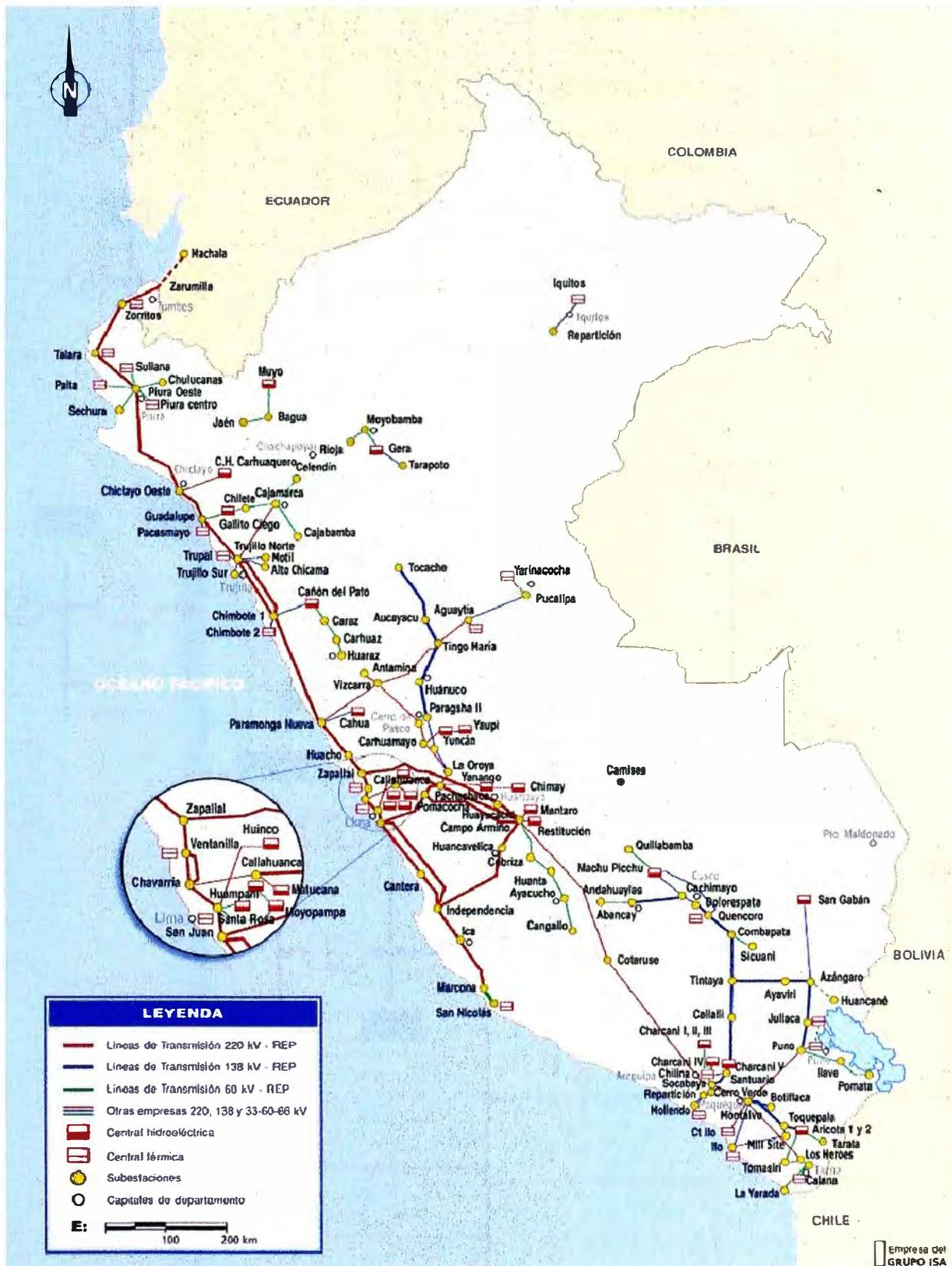
Fig. 3.1 Mapa del Perú con el diagrama unifilar del Sistema Interconectado
