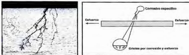
Fig. 3.5 Corrosión por esfuerzo
