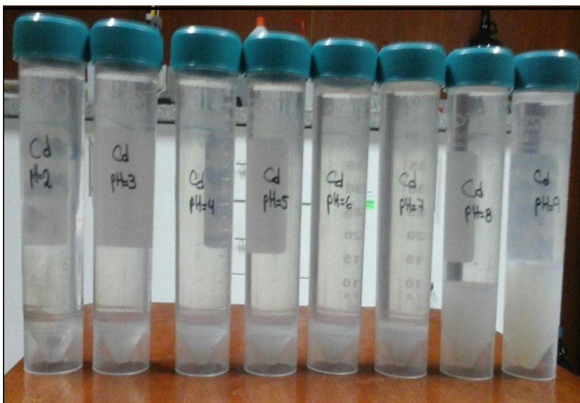
Figura 44. Fotografía del Alg-TSC luego de la sorción con cadmio (500 ppm) a diferentes condiciones de \text{pH} .
