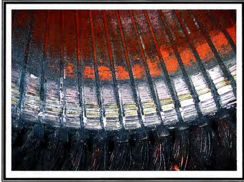
Figura 5.4 Rozamiento de Rotor con Estator, grave daño en las Laminas de Hierro Silicoso
