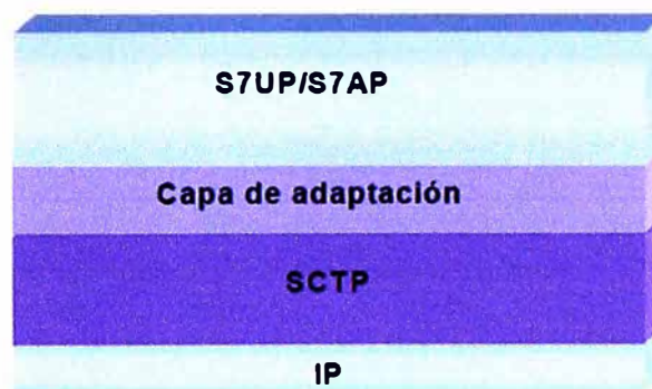
Figura 2.10 Arquitectura protocolos SIGTRAN
