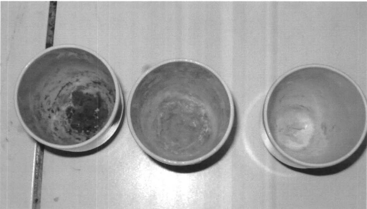
Foto N° 19: Cenizas del crisol con la muestra de aceite de la trampa de aceites (blanco) es menor que las cenizas de los otros crisoles que son residuales (el rojo y negro)
